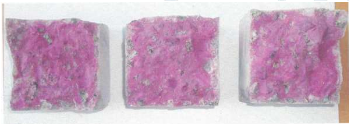
Hình 2: Các mẫu có Penetron Admix ở 14 ngày (A)
