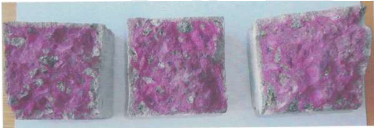
Hình 1: Các mẫu có Penetron ở 14 ngày (P)
