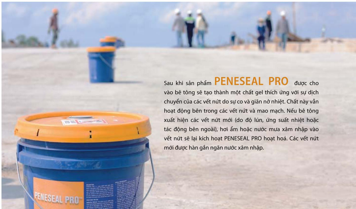
Sau khi sản phẩm **PENESEAL PRO** được cho vào bê tông sẽ tạo thành một chất gel thích ứng với sự dịch chuyển của các vết nứt do sự co và giãn nở nhiệt. Chất này vẫn hoạt động bên trong các vết nứt và mao mạch. Nếu bê tông xuất hiện các vết nứt mới (do độ lún, ứng suất nhiệt hoặc tác động bên ngoài), hơi ẩm hoặc nước mưa xâm nhập vào vết nứt sẽ kích hoạt PENESEAL PRO hoạt hoá. Các vết nứt mới được hàn gắn ngăn nước xâm nhập.
