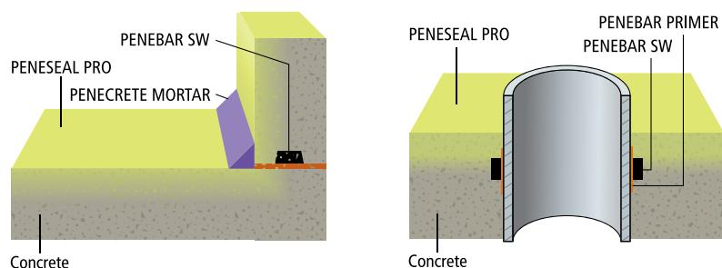
**Khớp nối:** Sử dụng kết hợp nhiều loại sản phẩm, bao gồm băng cản nước PENEBAR SW (khe co giãn mới) và vật liệu tinh thể PENETRON (mạch ngừng thi công).
