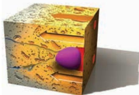
Tinh thể Penetron® lan rộng ra khắp bề mặt bê tông, tăng cường độ nén
