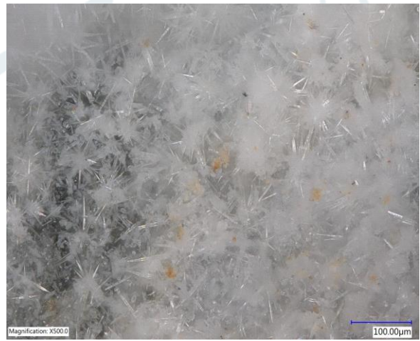
Hình 1 & 2: Tinh thể phát triển bên trong vết nứt bê tông (hình trái chụp phóng đại x100, hình phải chụp phóng đại x500)
