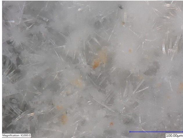
Hình 3: Tinh thể phát triển bên trong vết nứt bê tông (hình chụp phóng đại x1000)
