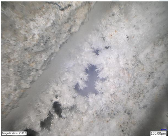
Hình 1 & 2: Tinh thể phát triển bên trong vết nứt bê tông (hình trái chụp phóng đại x100, hình phải chụp phóng đại x500)
